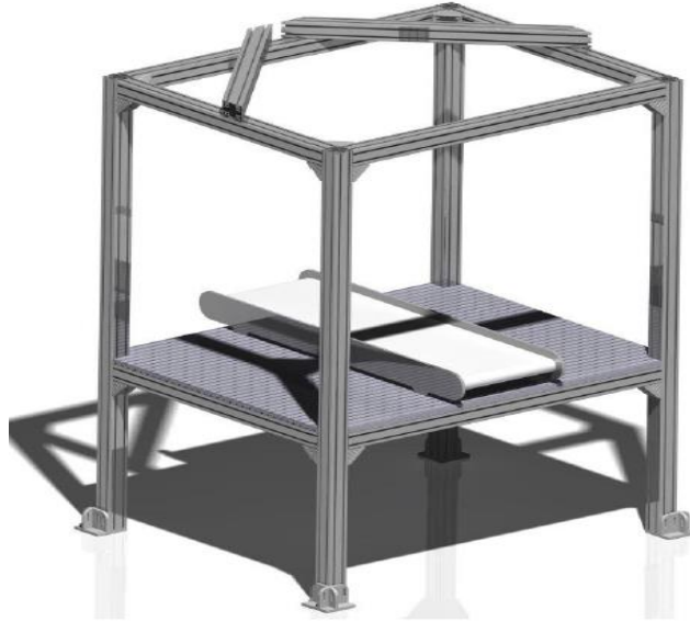
Figure II.3 : Modèle CAO du support robot Fanuc M3iA / 6S avec système de transport associé
