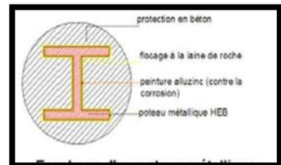
**Figure 141: enrobage d'un poteau métallique en béton**
