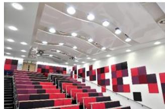
**Figure 160 :** les baffles acoustiques
