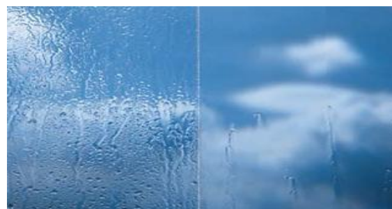
Figure 178. Différence entre verre simple et verre autonettoyant Source. blog.equipbaie.com
