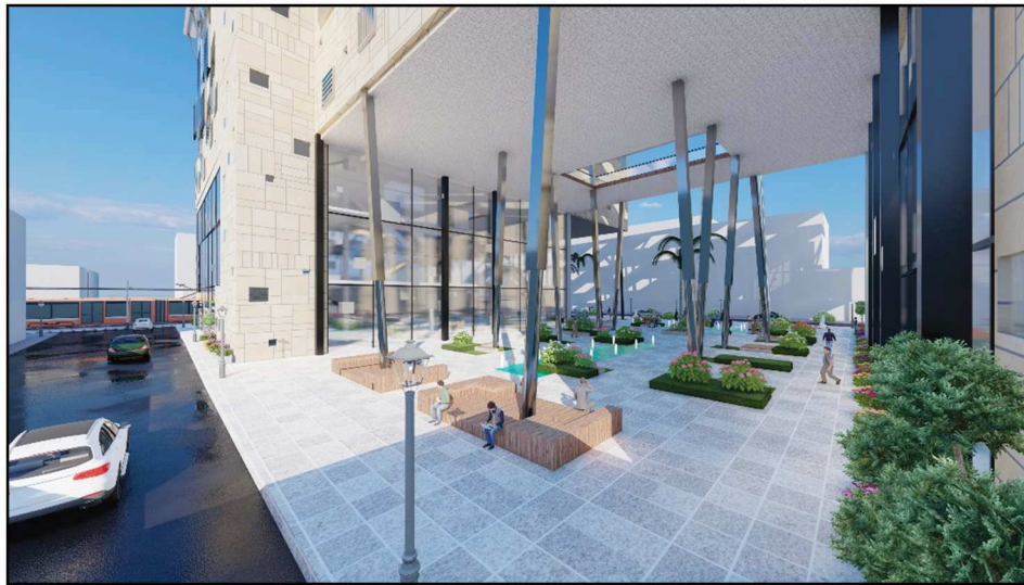
Figure 69: rendu montrant les poteaux inclinés
