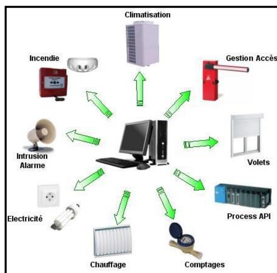
Figure 145. Principe de la GTB
