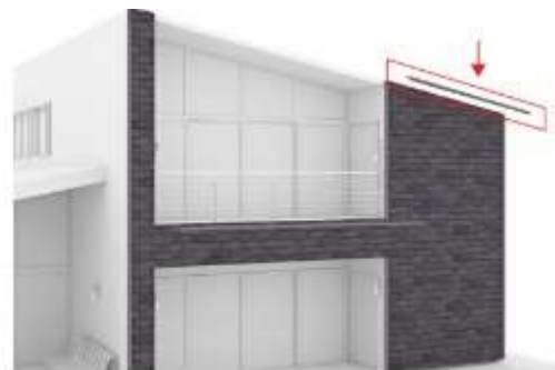
Figure 64 facade ventilée schema de tôle métallique d'acrotère
