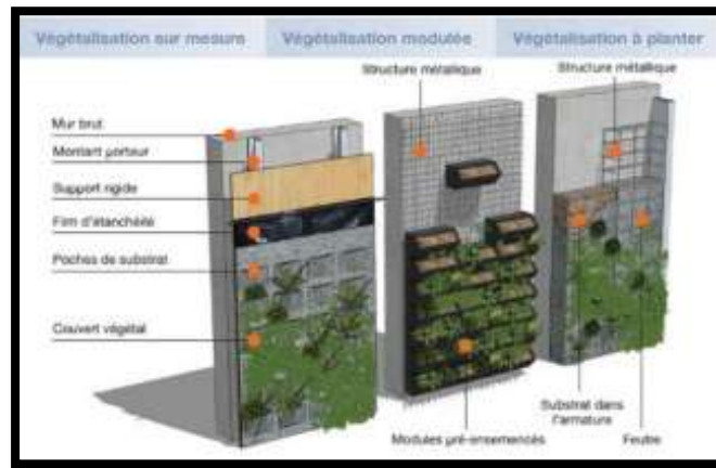
Figure 104 Composition de la façade végétale
