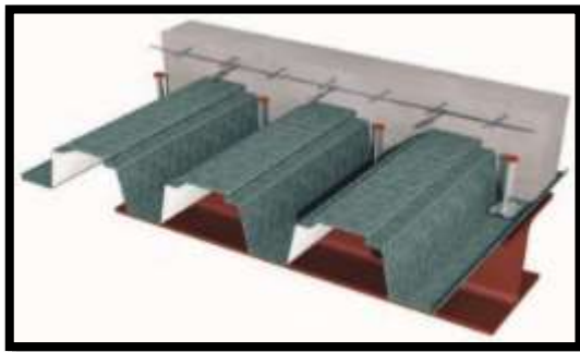
Figure 289 Schéma du Plancher collaborant pour l'ensemble du musée
