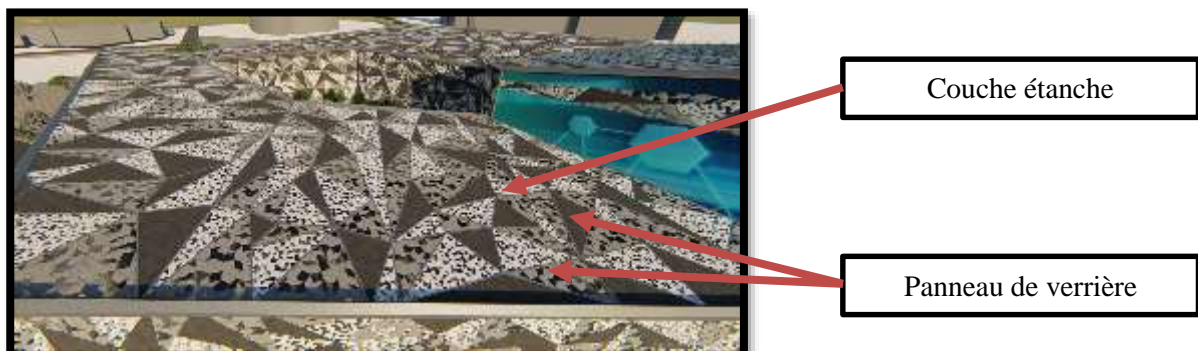
Figure 349 L'étanchéité pour les verrières
