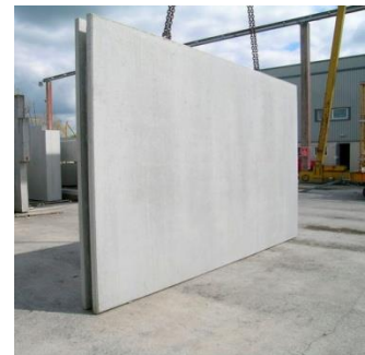
Figure 95: pré mur en béton
