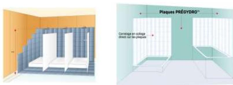
Figure 115 : cloison des espaces humides
