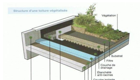
Figure 70: les composants d'une toiture végétalisée
