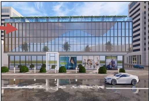
Figure 78 : utilisation de claustra sur façade en mur rideau
