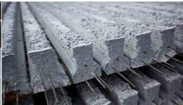
Figure 11 : Voiles de rampe préfabriquées
