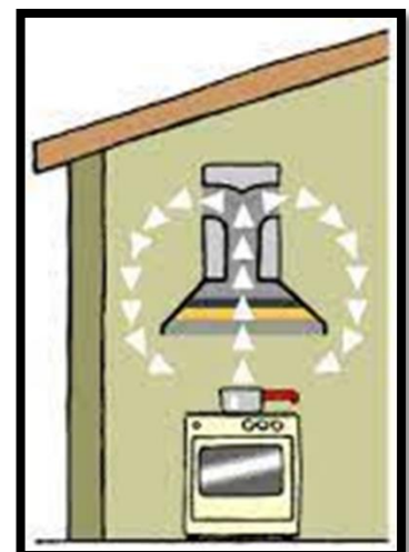
Figure 144: principe de travail de la hotte aspirante
