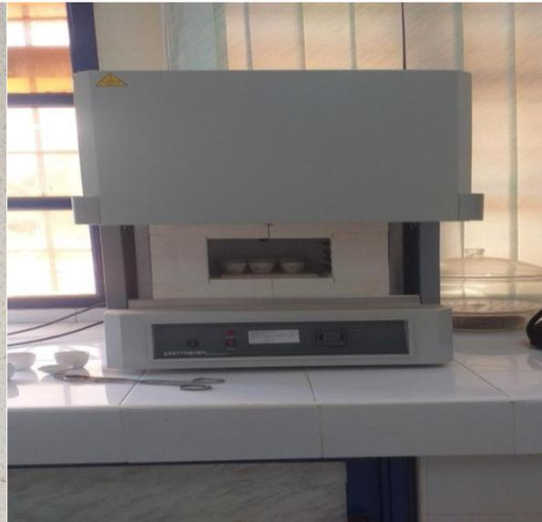
**Photo7:** Les échantillons dans un four d'incinération **Photo 8:** Le four d'incinération
