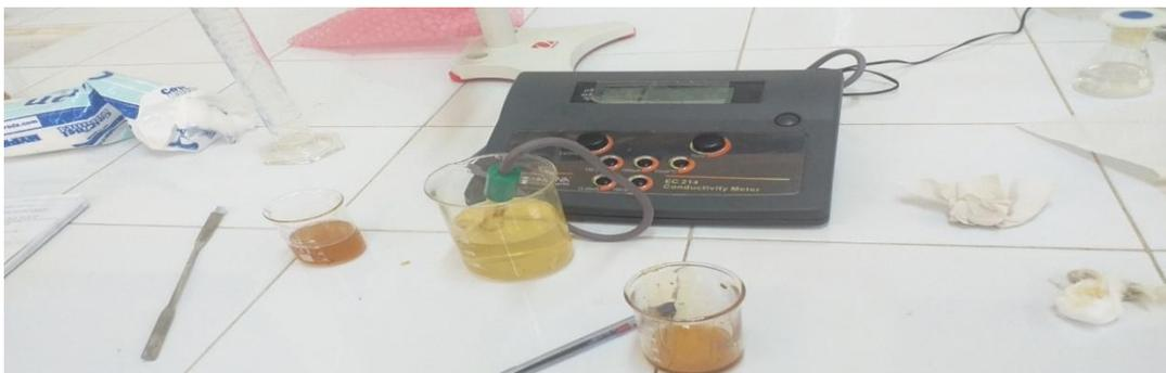
**Photo 6** : Le conductimètre avec la solution de miel (BELMELIANI, 2020)
