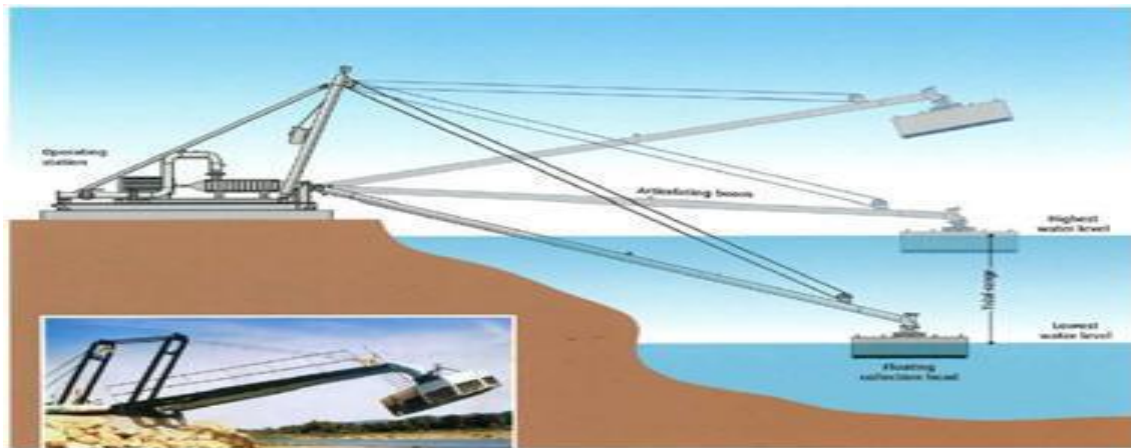
Figure 2.5.5: Prise d'eau mobile 15
