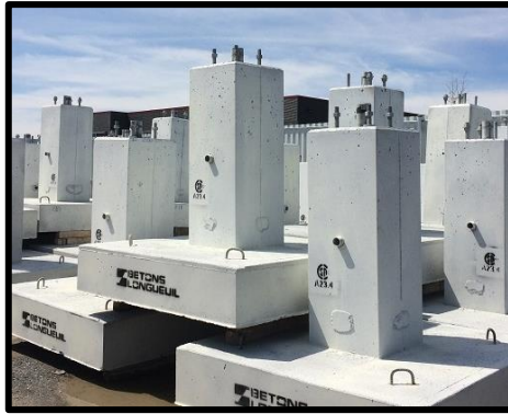
Figure 153. Exemple fondations préfabriquées. 60
