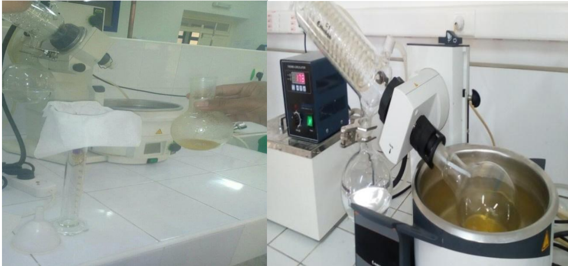
Figure10 : Filtration du matériel végétale (à gauche) et évaporation du méthanol (à droite).
