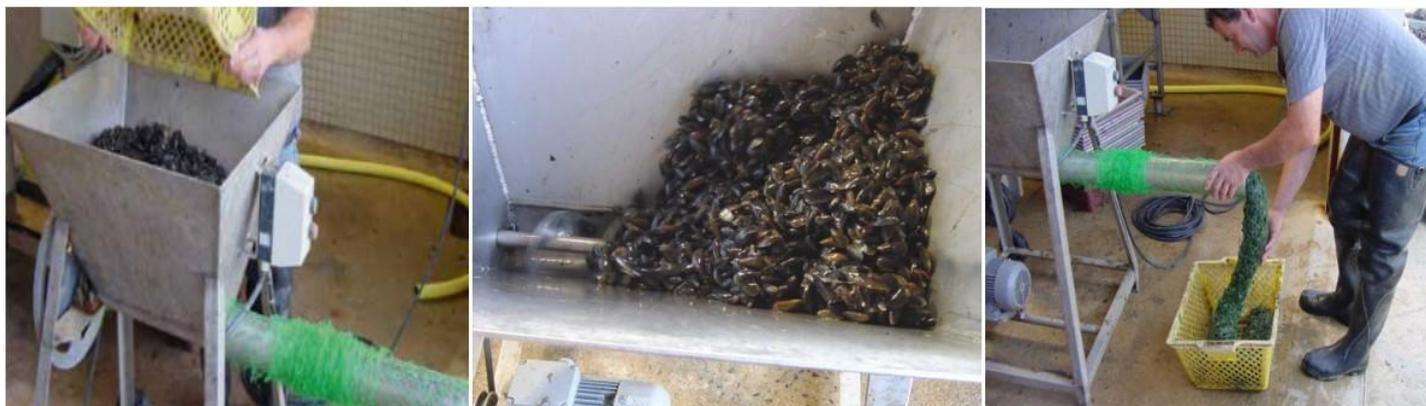
**Figure 34:** Boudineuse, permet de mettre les moules en boudin. Les moules sont placées dans une trémie (à gauche sur la photo) et entraînées, par une vis sans fin, vers le filet pour former le boudin (à droite sur la photo) (Source : [www.mulot.fr](http://www.mulot.fr)).
