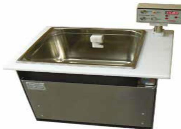
Figure 6 : Cuve de nettoyage par ultra-sons (Offner et al. , 2016)
