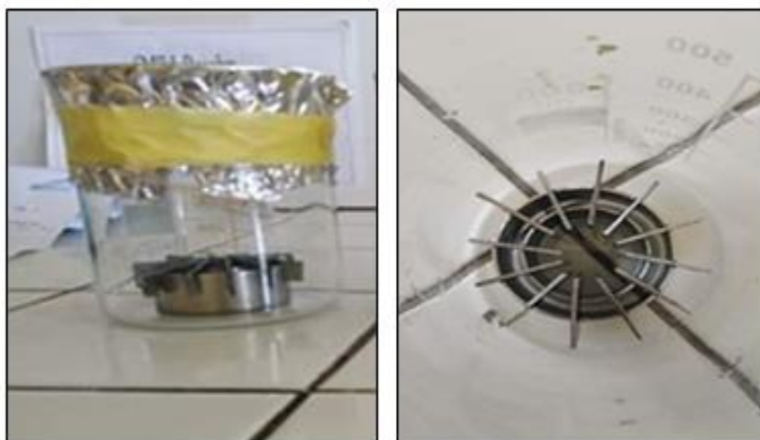
Figure 8 : Le système d'acier inoxydable utilisé pour la formation des biofilms
