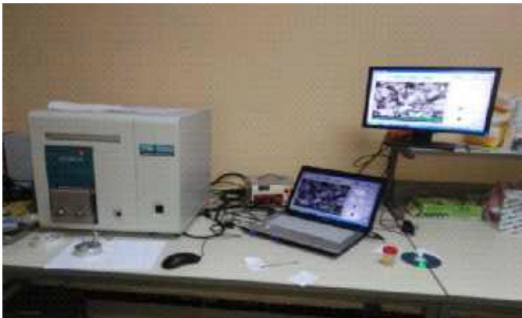
**Figure 9 : Photo de l’appareil FEI MEB QUANTA 45.**
