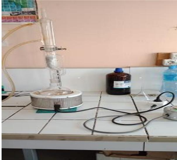
**Figure II.3:** Système d'extraction au Soxhlet.
