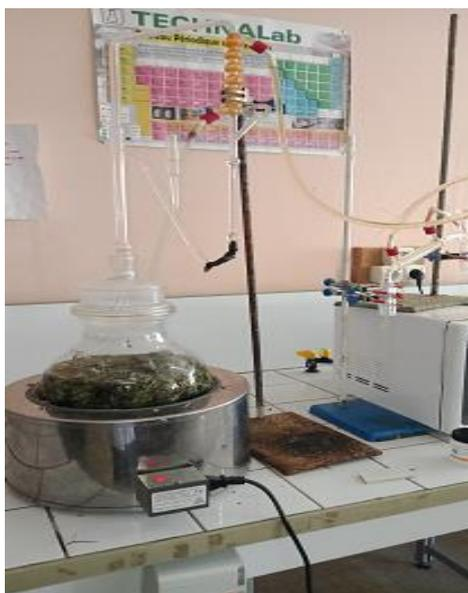
**Figure II.2 :** Montage d'hydrodistillation
