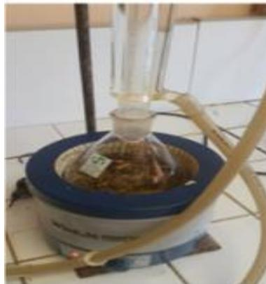
**Figure II.6 :** Montage à reflux
