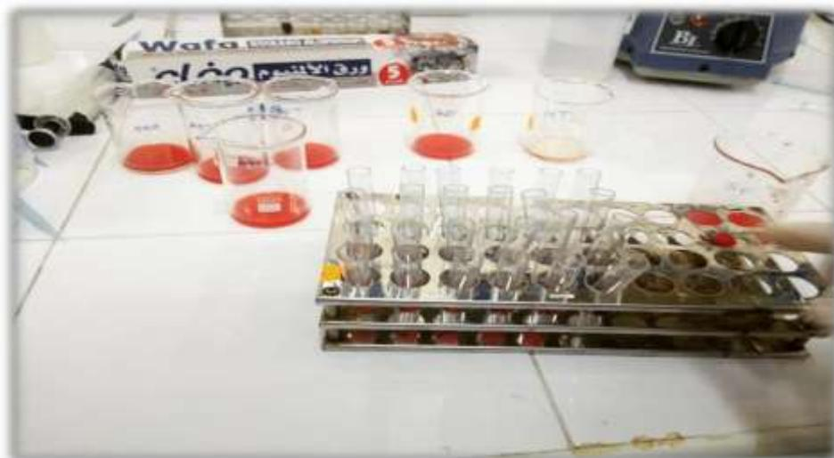
**Figure10** : Préparation des solutions à base de la suspension d'érythrocytaire, PBS, eau distillée (photo de laboratoire)
