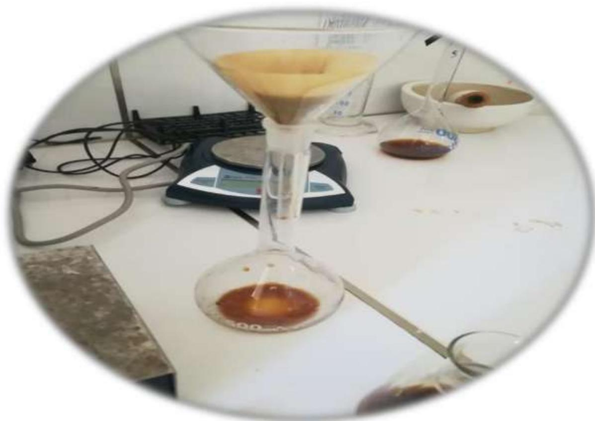
**Figure 8 :** Filtration des extraits obtenus (photo de laboratoire)
