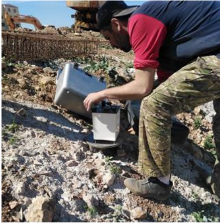
Figure 9 : Mesure gravimétrique sur terrain.
