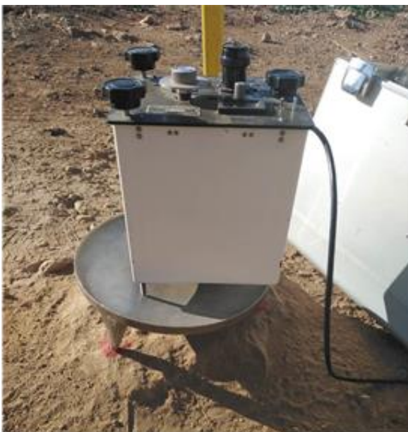
Figure 7: Le gravimètre Lacoste Romberg (Modèle utilisé sur le terrain).
