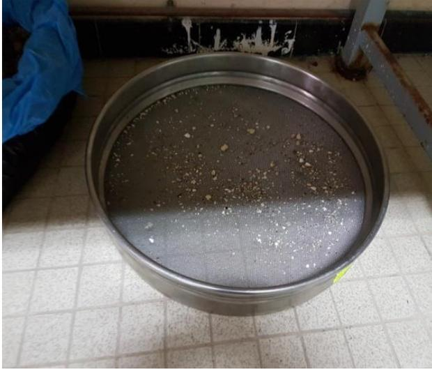
**Figure 03 :** le tamis utilisé pour tamisage.
