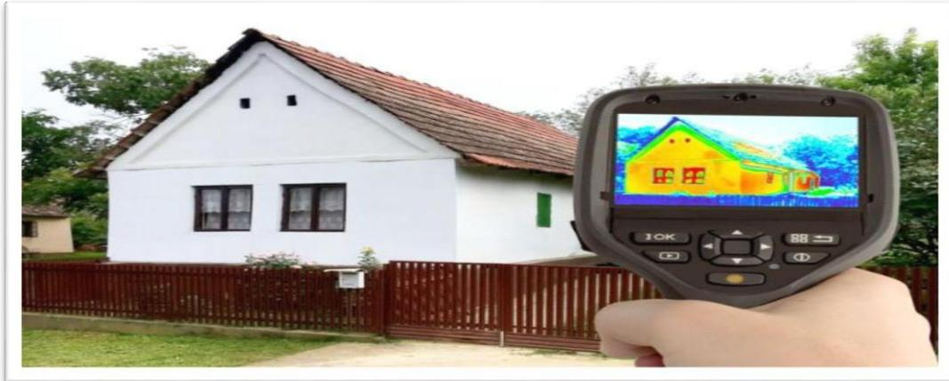
**Figure II .1 :** Exemple des pertes de chaleur par caméra infrarouge
