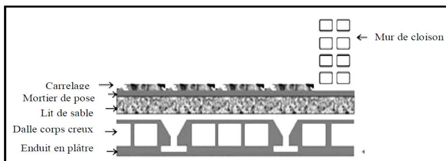
Figure II.8: Plancher étage courant
