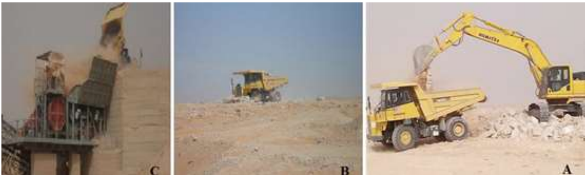
Fig. 16: Différentes étapes de chargement (A), de transport (B) et de déchargement (C).
