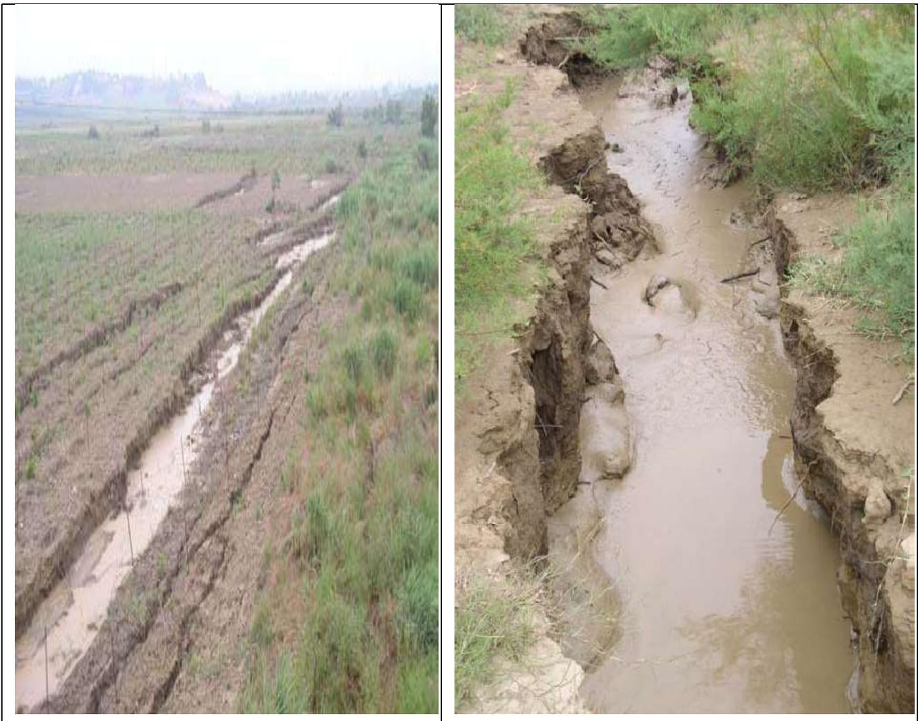
**Figure 1.7** Liquéfaction du sol aux abords de l'oued Isser. Séisme Boumerdès, 2003 (Benahchilif 2016)
