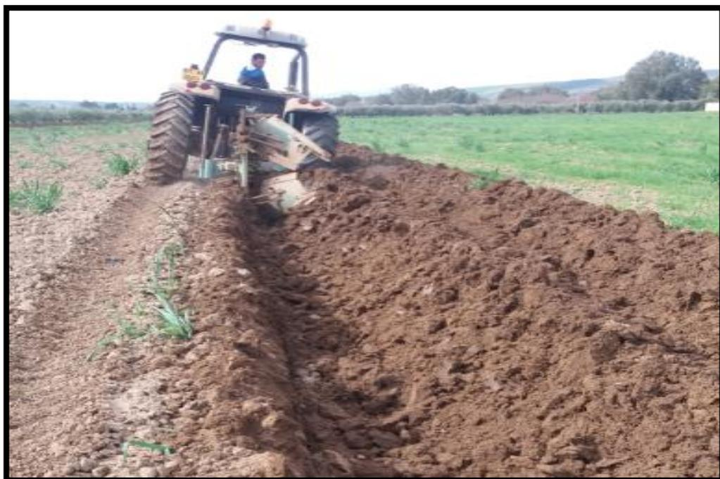
Figure 10 : Photo illustre la procédure de labour profondeur par un réversible à bisoc.
