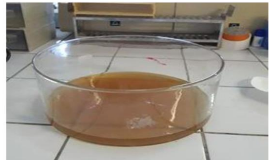
6- Echantillon obtenu après filtration avec papier Whatman N°4
