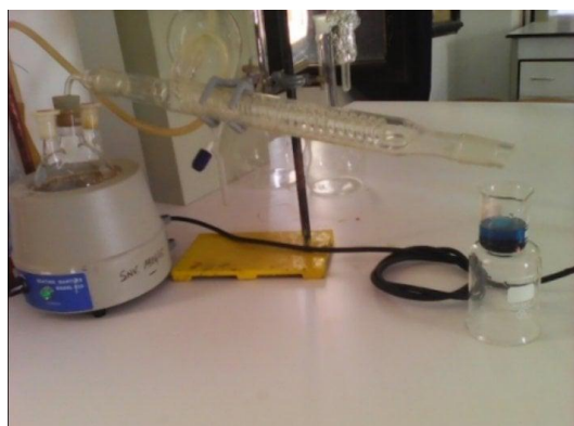
Figure 08 : Distillation de l'échantillon (Halla et Chaib, 2017)
