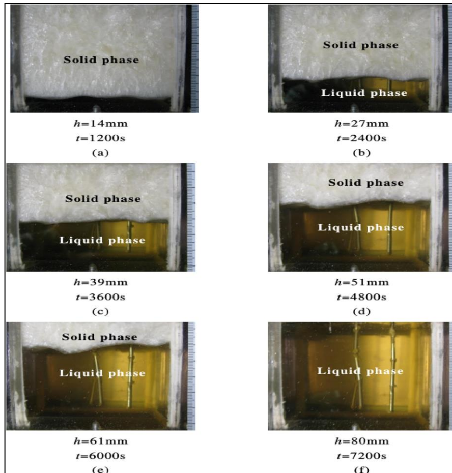
Figure II. 9. Evolution expérimentale de la fraction liquide
