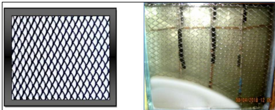
Figure II. 5. Fusion d'un MCP dans une cavité avec une grille de ZAMAK
