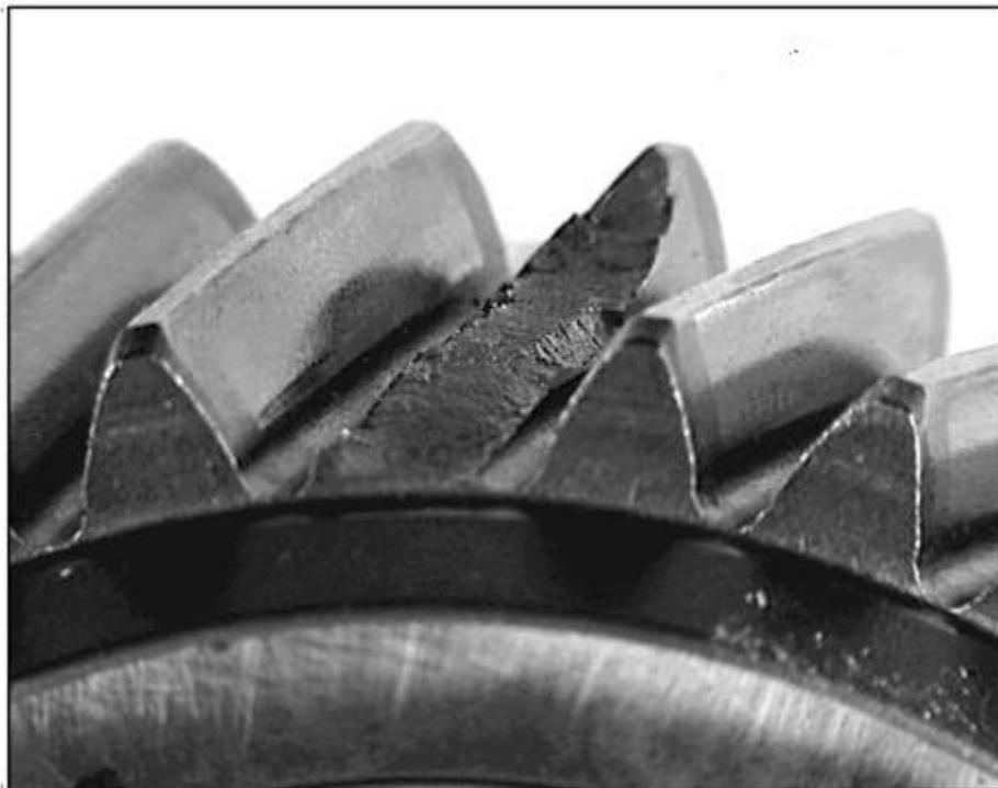
*Figure 29 Rupture par fatigue*
