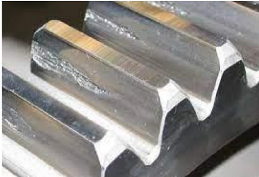
*Figure 30 Rupture par écaillage*
