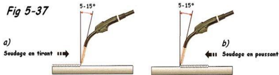
Figure II. 18 soudages en tirant ou poussant [35]
