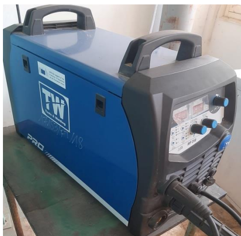
Figure II. 42 Poste soudage Multi-procédé MP250
