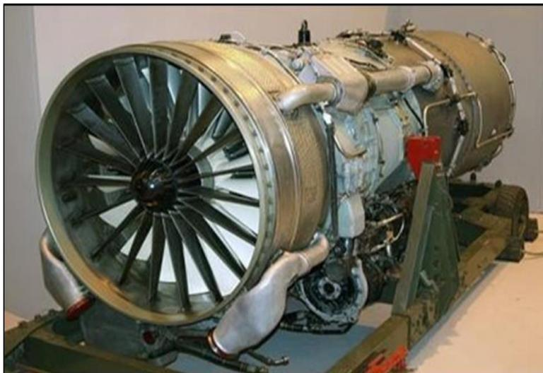
Fig.9: Premier turboréacteur double flux« Rolls-Royce
