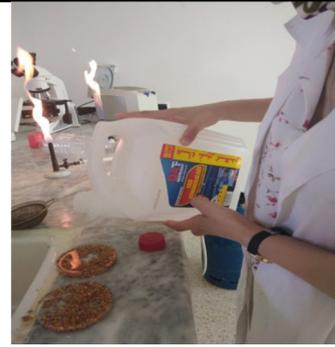
**Rinçage des grains avec l'eau distillé**
