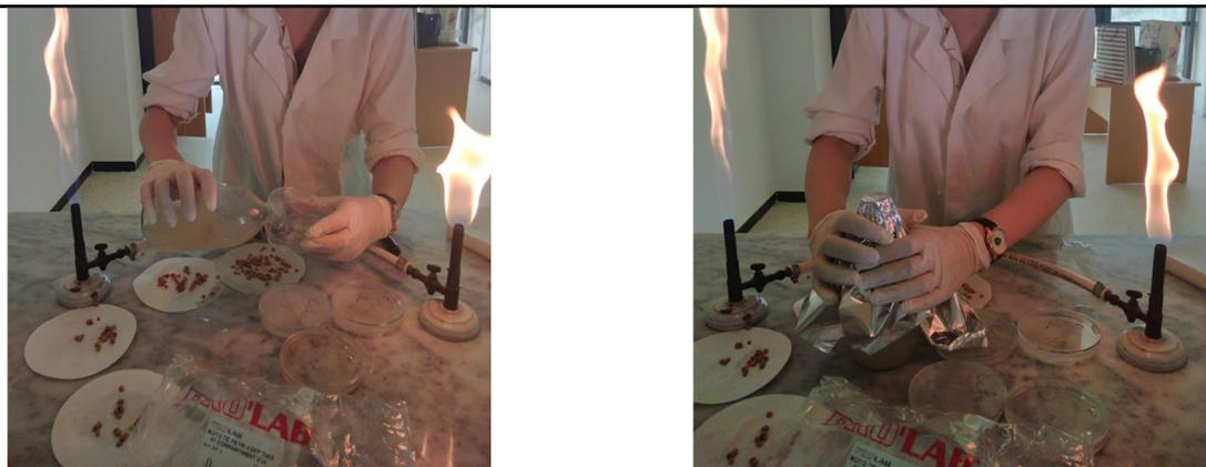
**Figure 24 : Ecoulement le milieu PDA dans les boites de pétri**
