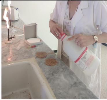
**Trempe les grains dans l'alcool**
