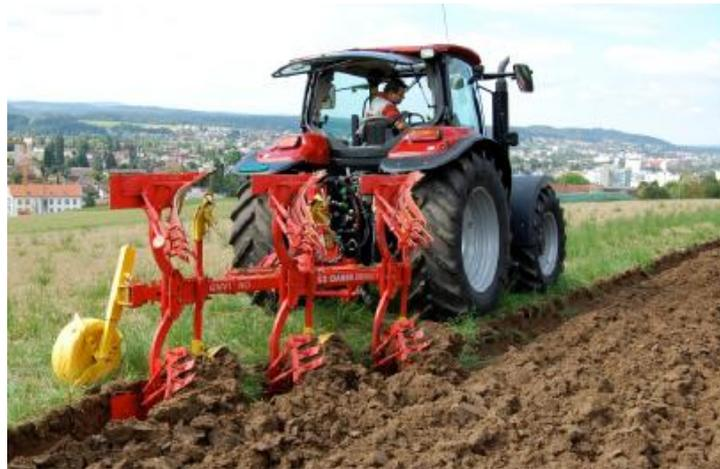
**Figure N°16 :** Machine pour labour hors-raie (hors-sillon) (FIBL., 2013)
