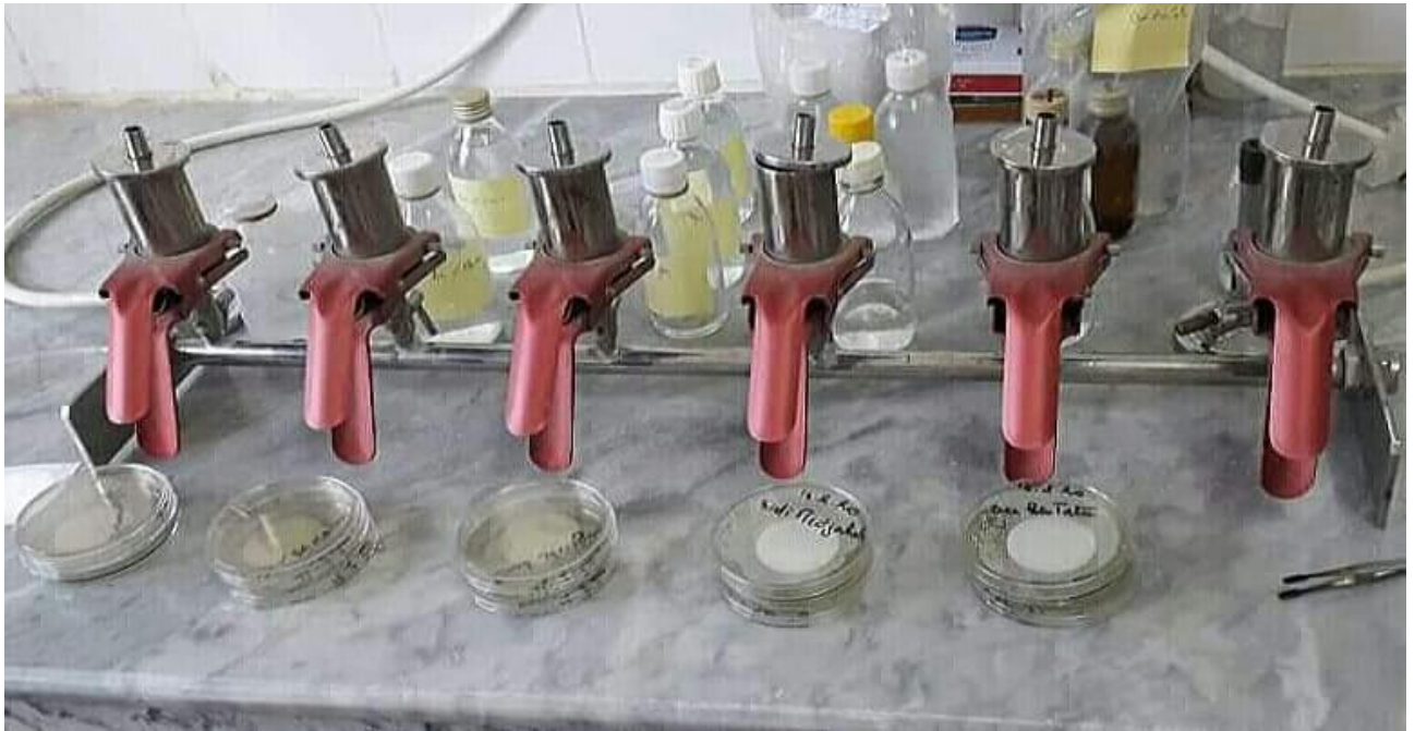
Figure 05 : La rampe de filtration.
