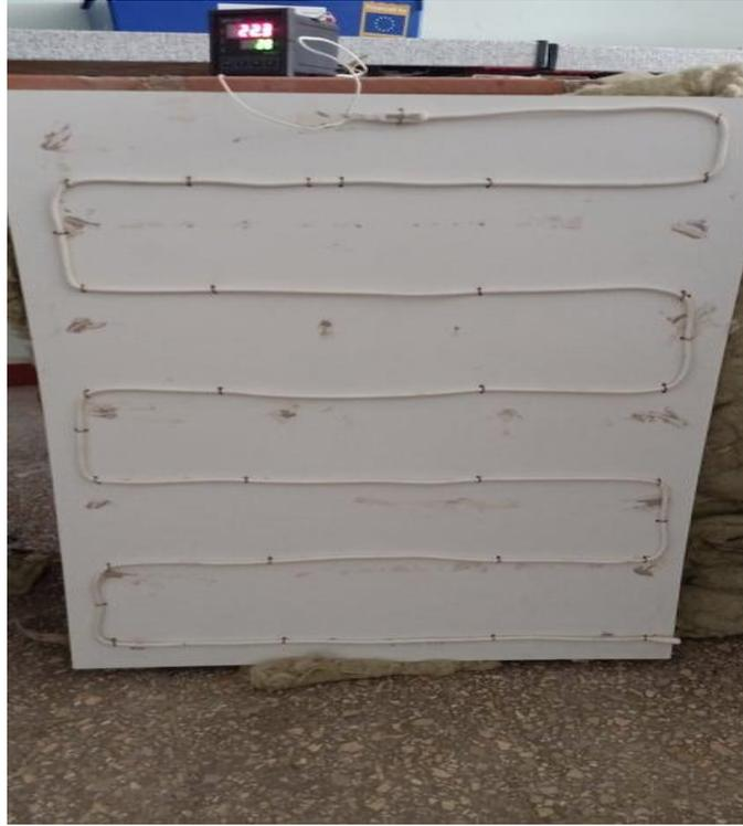
Figure III -17 Résistance électrique
