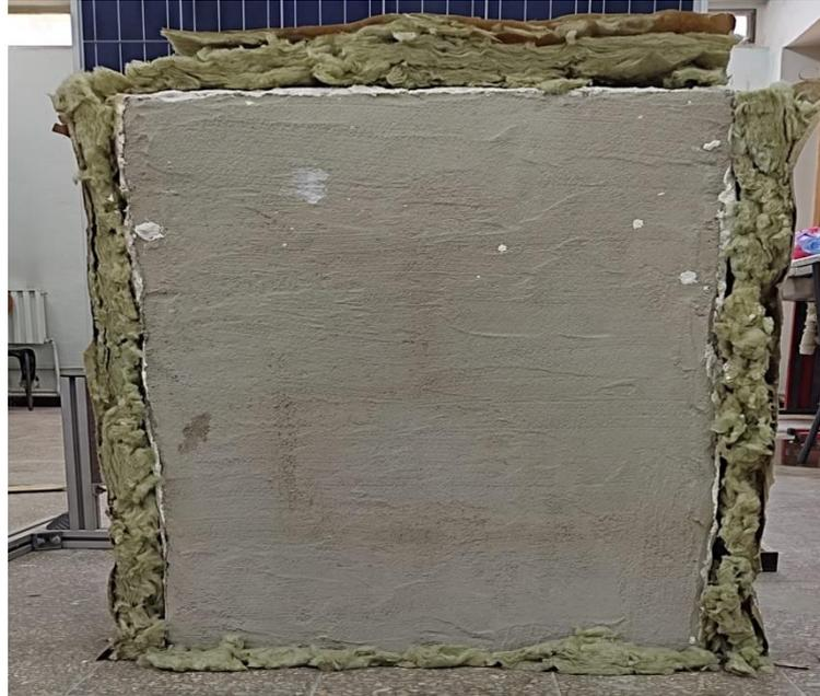
Figure III.3 : Mur en brique avec une plaque de mortier.
