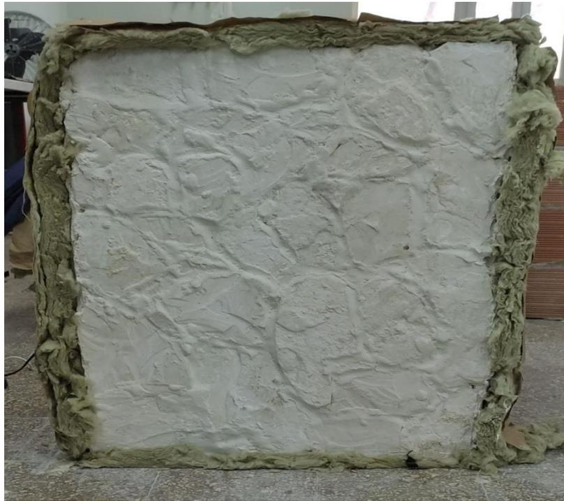
**Figure III.1** : Mur en brique avec une plaque de diatomite.
