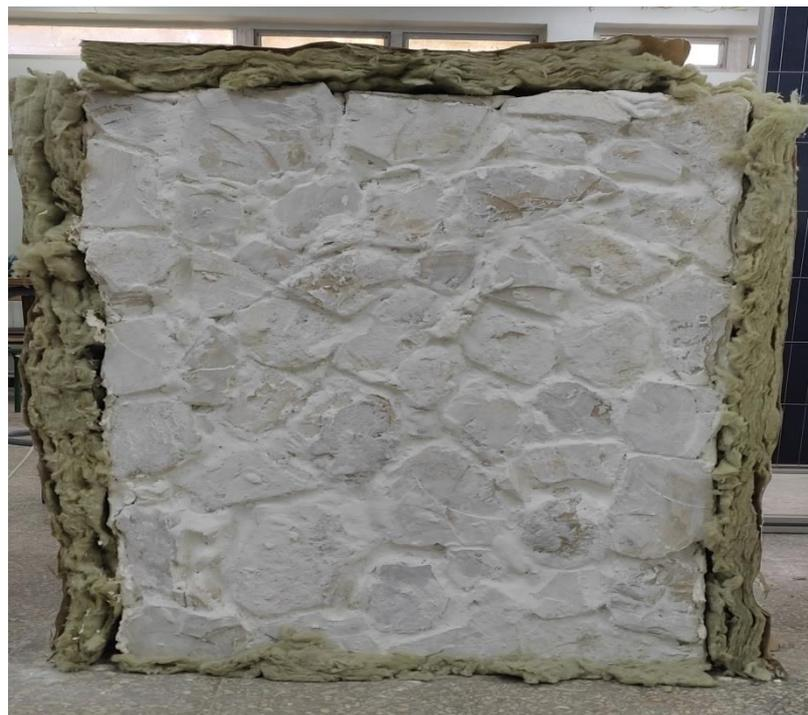
**Figure III.2** : Mur en brique avec une plaque de diatomite+ paraffine.
