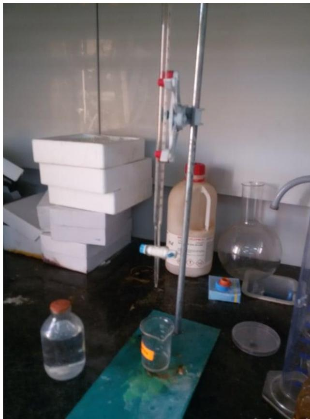
Figure 7 : Dosage par alcalimétrie d'acidité
