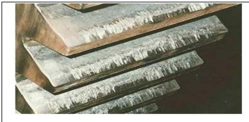
**Figure 2.2** Grippage localisé sur les têtes de dent. [34]
