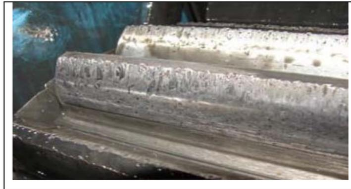
**Figure 2.7** Grippage couvrant l'ensemble des dentures. [34]
