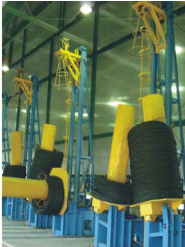
Figure II.5-4: Dévidoir vertical double axes.[17].
