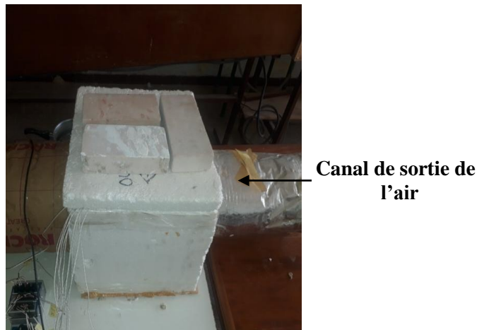
Fig.3 8. Isolation du stockeur thermique
