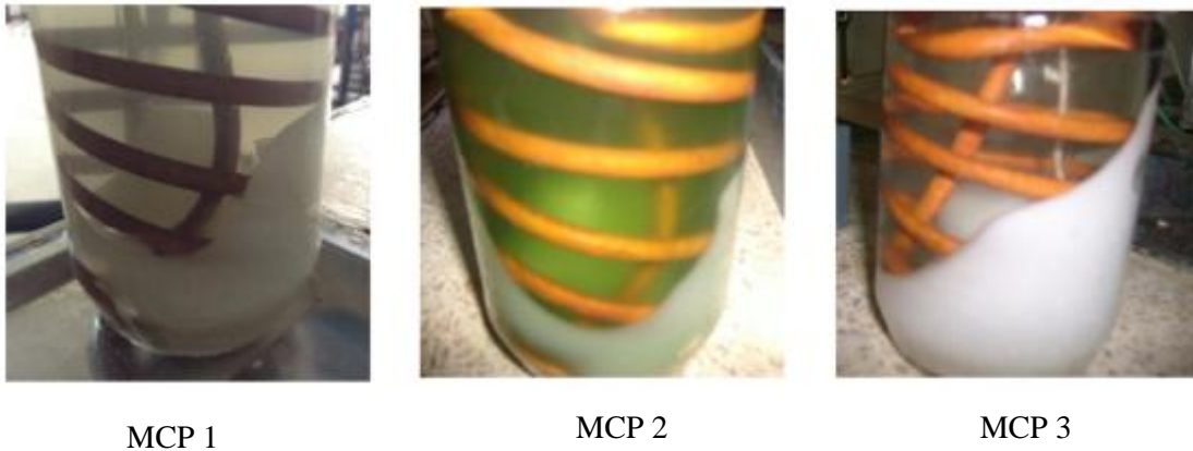
Fig. 1. 3. Fusion de 3 MCP à l'instant 53 min.
