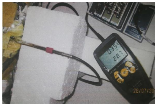
Fig.3 5. Débitmètre d'air à fil chaud placé directement à l'intérieur du canal
