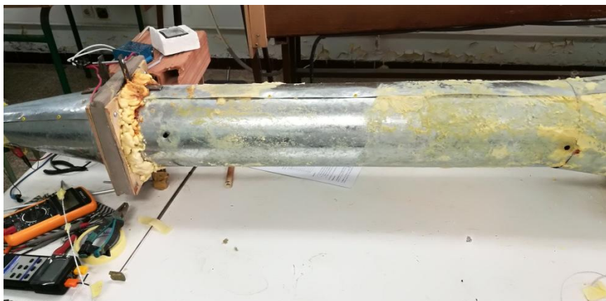
Fig.3 1. Canal d'air avant l'isolation
