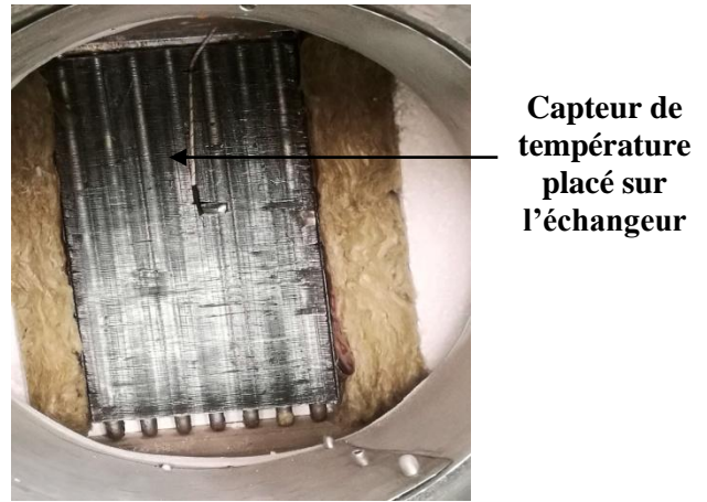
Fig.3 7. Échangeur isolé dans le stockeur
