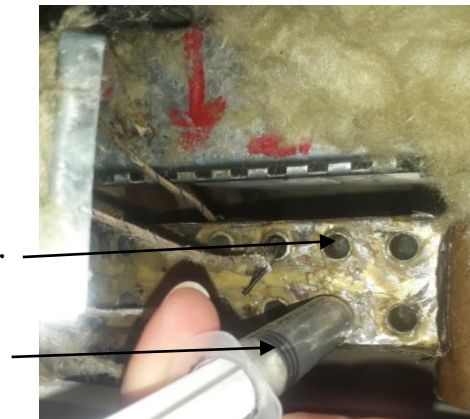
Fig.3 11. Remplissage des tubes de l'échangeur par la paraffine
