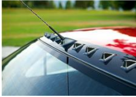
Figure I. 27 : Contrôle de l'écoulement avec des générateurs de vortex placés dans une lunette arrière d'un véhicule [9].
