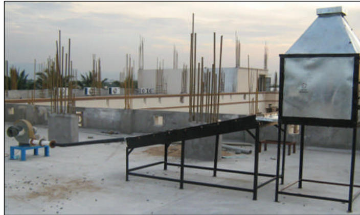
Figure II. 6 : La configuration expérimentale du séchoir solaire.
