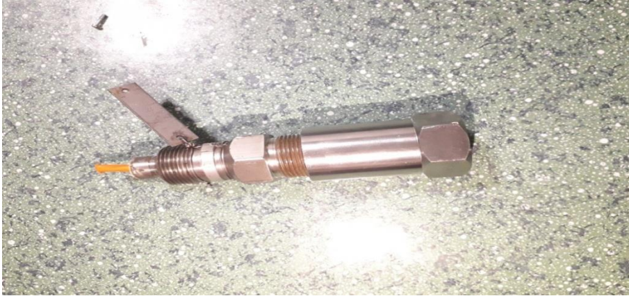
Figure I-17: Détecteur de flamme (Détecteur ultraviolet) [3].
