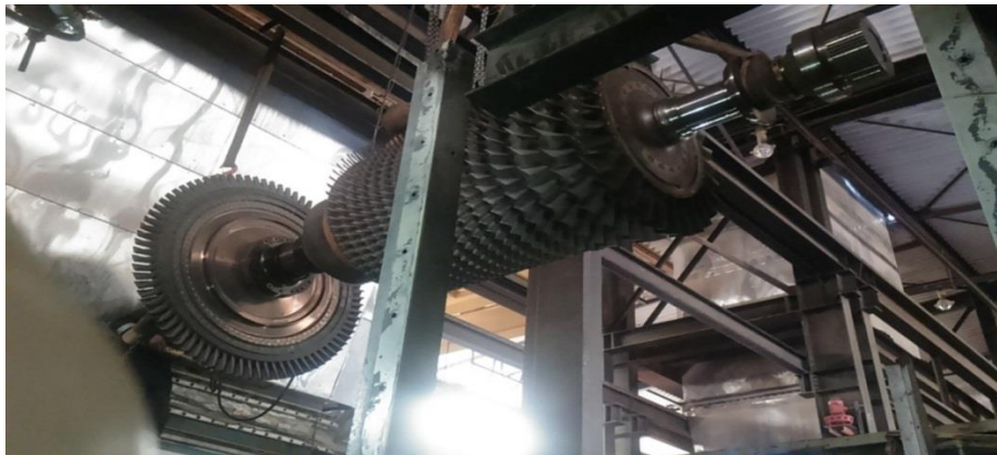
Figure I-8: Rotor du compresseur avec la roue HP [3].
