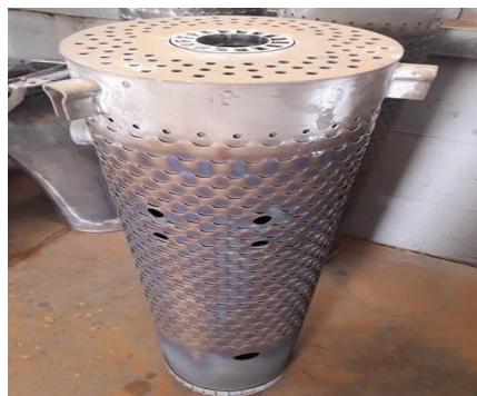
Figure I.13 : La chambre de combustion
