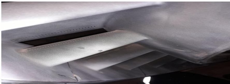
Figure I-11: Aubes 1er étage (Directrice 1er étage) les EGV.
