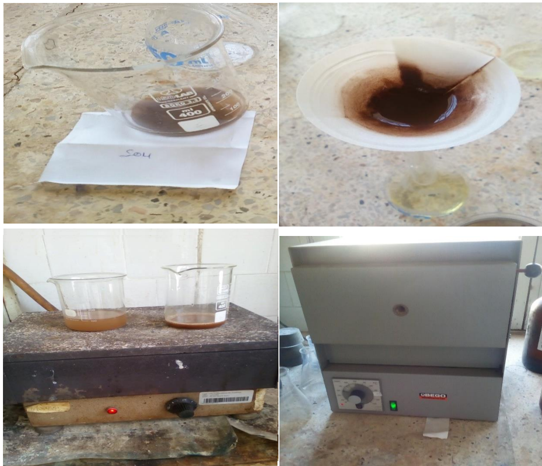
Figure 65 : Détermination des Sulfates
