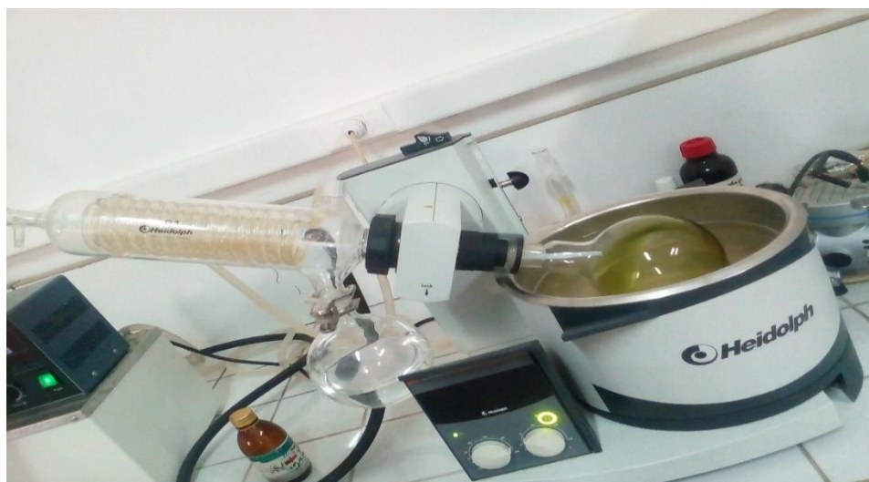
Figure 95 : Evaporation de l'extrait phénolique au Rotavapor à 45°C
