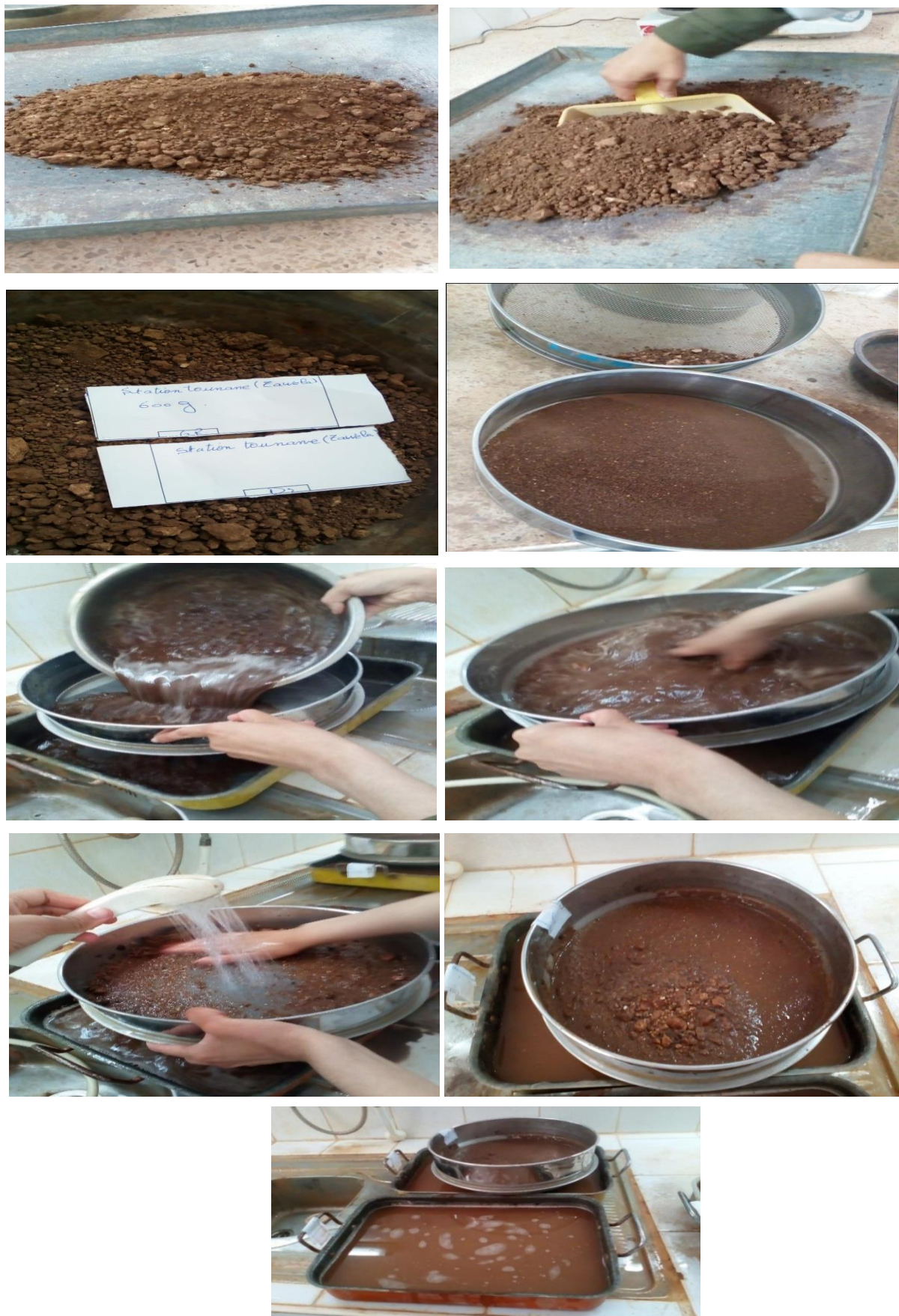
Figure 62 : Analyse granulométrique par tamisage à sec après lavage
