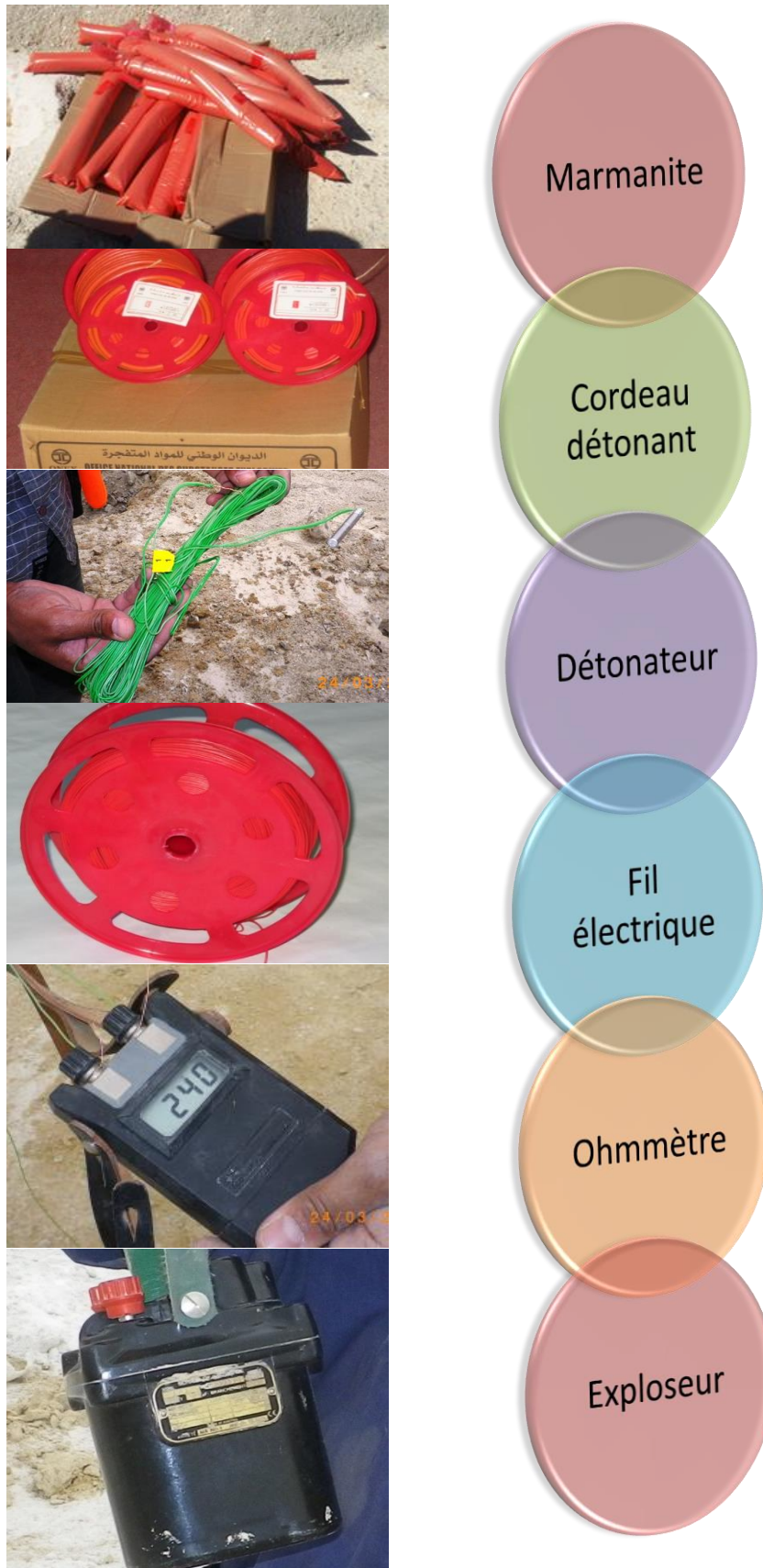
Figure 13 : Les différents éléments rentrant dans un tir de mine
