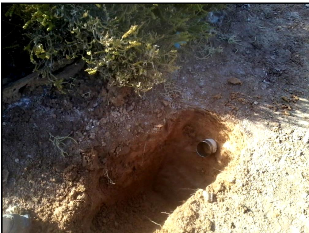
**Fig.36. Méthode de cylindre pour la mesure de la densité apparente**
