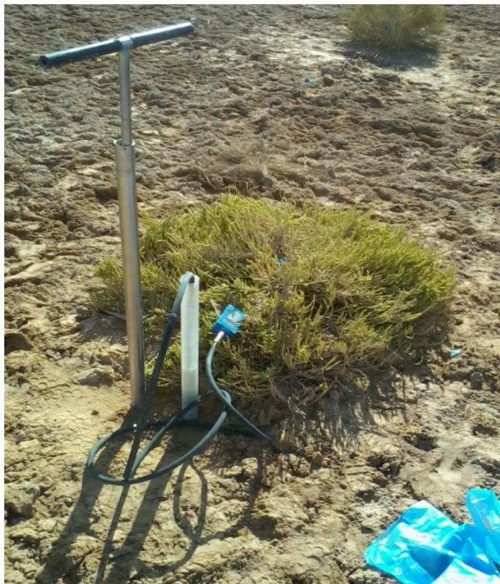
Fig.33. Détermination *in-situ* l'humidité du sol, la conductivité électrique et la rétention d'eau par une sonde TDR (*H.strobilaceum*)
