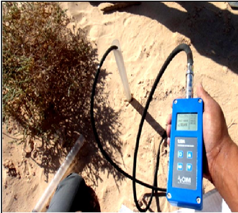
Fig.32. Détermination *in-situ* l'humidité du sol, la conductivité électrique et la rétention d'eau par une sonde TDR (*T.nudatum*)
