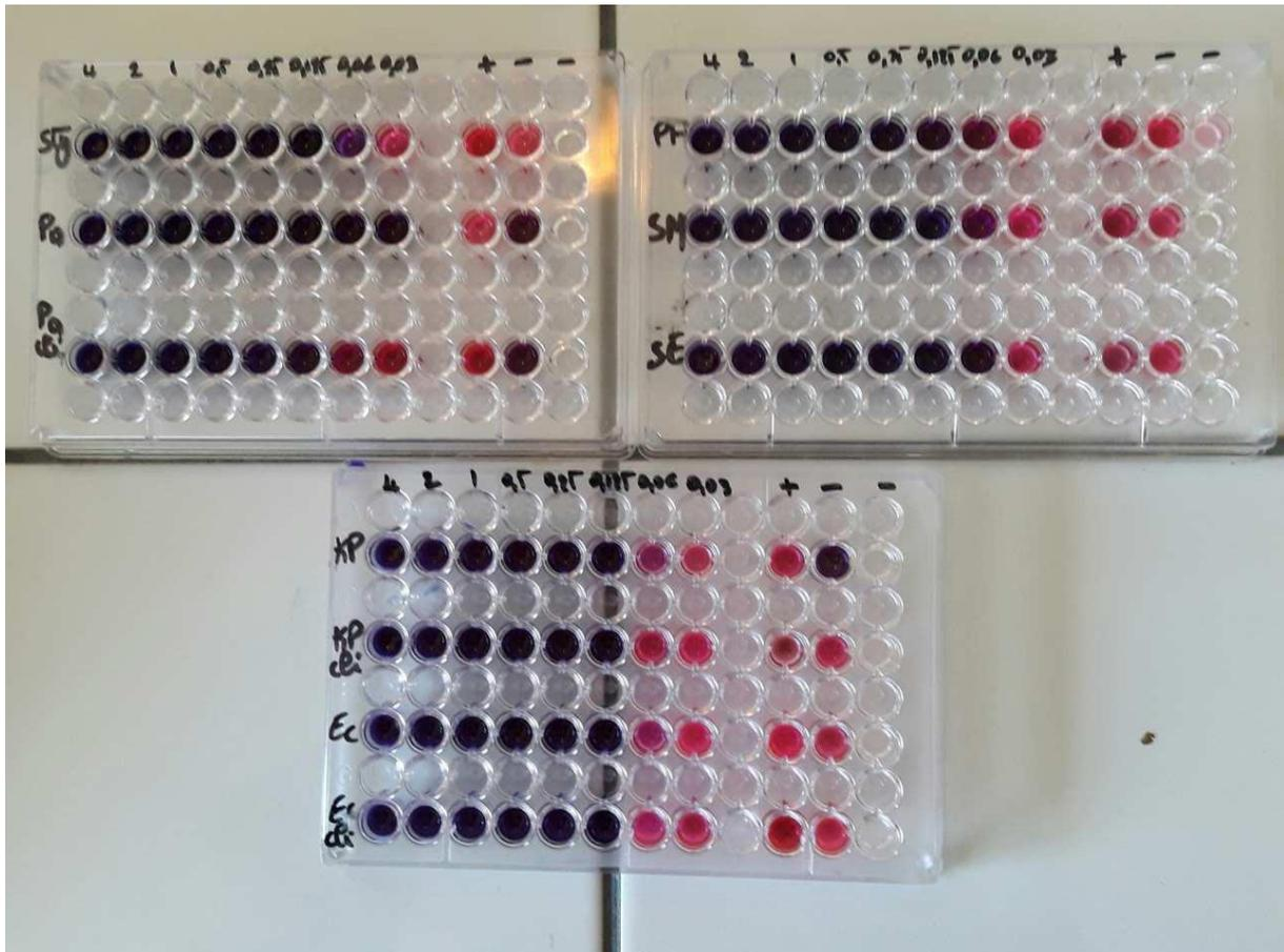
**Figure :** Méthode de CMI sur microplaque par l'utilisation de résazurine
