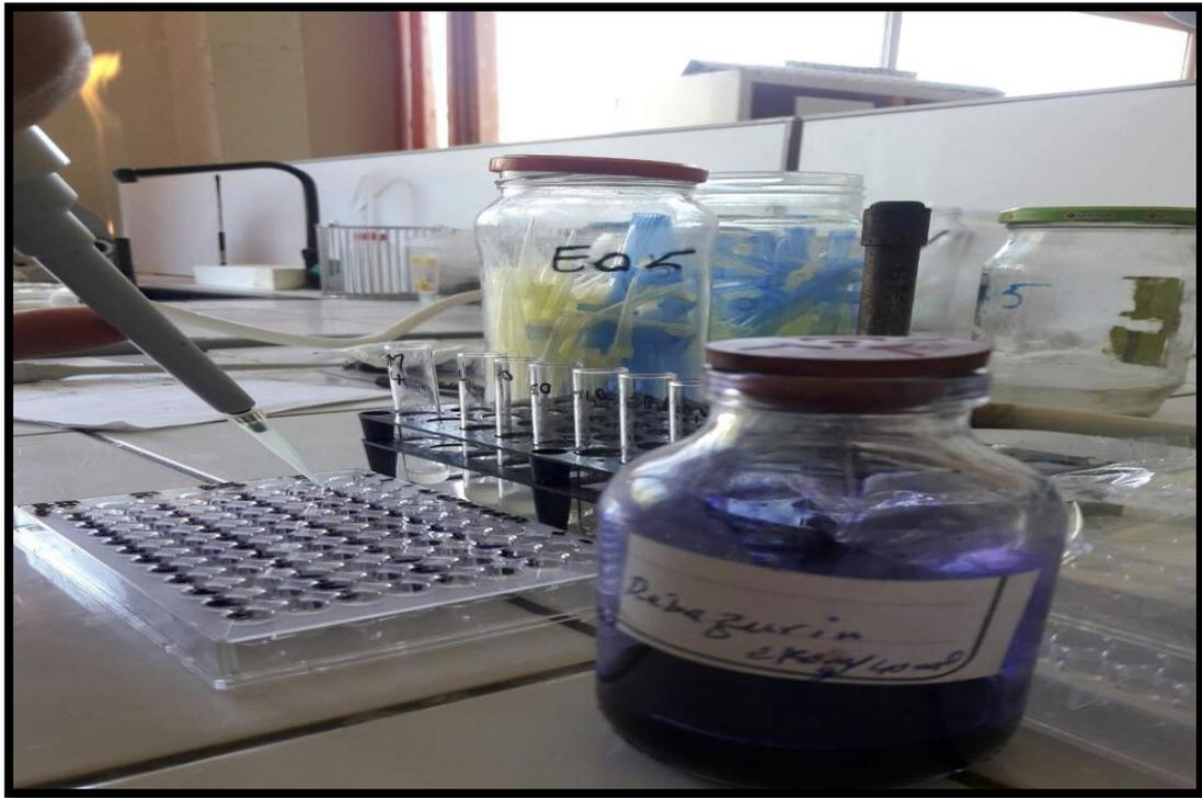
**Figure11** : Les procédures de la méthode de microdilution par la résazurine
