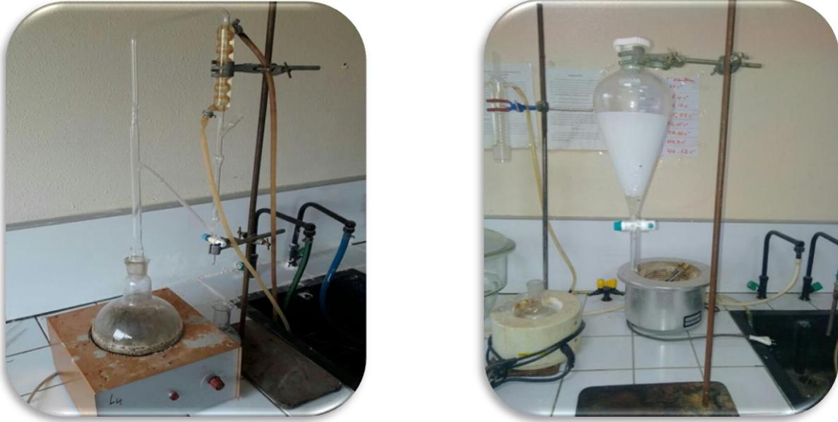
**Figure 8:** Montage de type Clevenger pour l'hydrodistillation et l'extraction de l'HE de *S. aromaticum*
